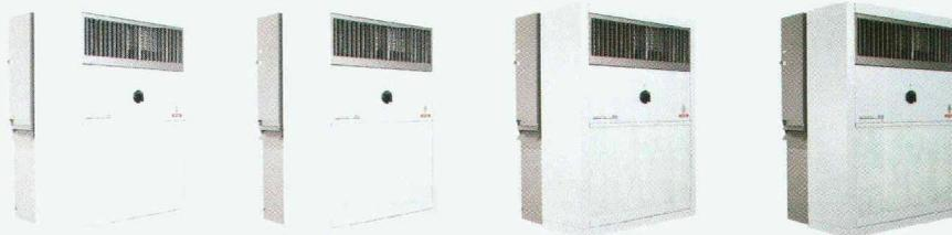
**Bora 150** für Räume bis 40 m<sup>3</sup>, Wasserentzug 21 Liter in 24 Stunden, **Bora 250** für Räume bis 60 m<sup>3</sup>, Wasserentzug 29 Liter in 24 Stunden, **Bora 450** für Räume über 60 m<sup>3</sup>, Wasserentzug bis zu 41 Liter in 24 Stunden, **Bora 450 Vario**, Luftmenge und Wurfweite einstellbar, Wasserentzug bis 43,6 Liter.
